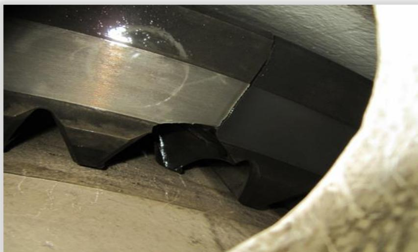
图 4.2 建投某齿轮箱突发断齿案例验证照片
